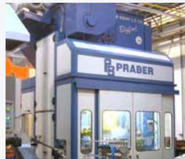
Linea di presse PRF-CS ad alta rigidità per lo stampaggio a caldo dei metalli ferrosi e non ferrosi a ciclo singolo e ciclo continuo.
