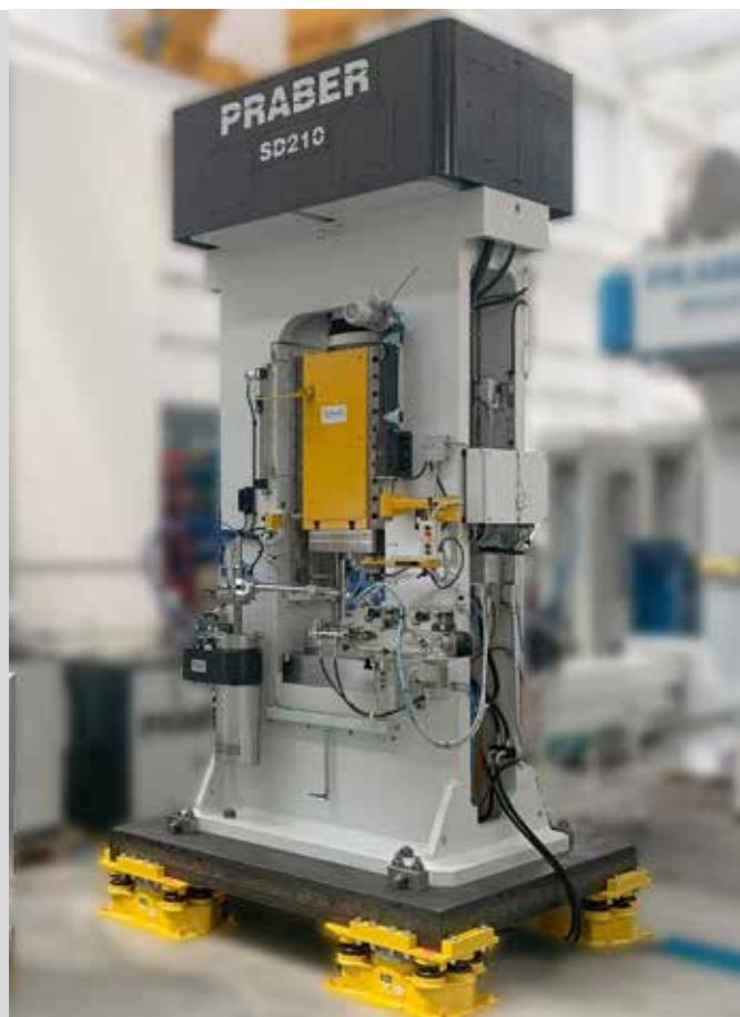
Die SD-Spindelpressen zeichnen sich durch ihre überlegene Präzision, den reduzierten Energieverbrauch und den geringeren Wartungsbedarf aus. Diese technologische Verbesserung wurde durch den Austausch der traditionellen Bewegung mittels Scheiben gegen einen direkt mit der Spindel-Schraube gekoppelten Drehmomentmotor ermöglicht. Diese Innovation macht die Maschinen nicht nur zuverlässiger, sondern erhöht auch die Betriebseffizienz und Langlebigkeit.
